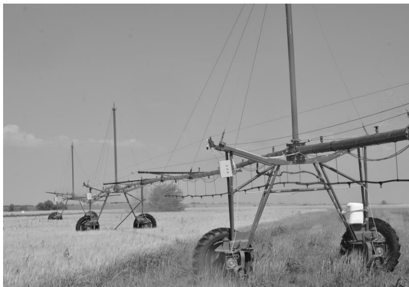
Рисунок 1 – Общий вид широкозахватной многоопорной дождевальной машины кругового действия «Дон-К» (автор фото А. А. Чураев)
