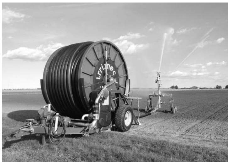
Рисунок 1 – Шланго-барабанная дождевальная машина (установка) фирмы Irrimes (Италия)
