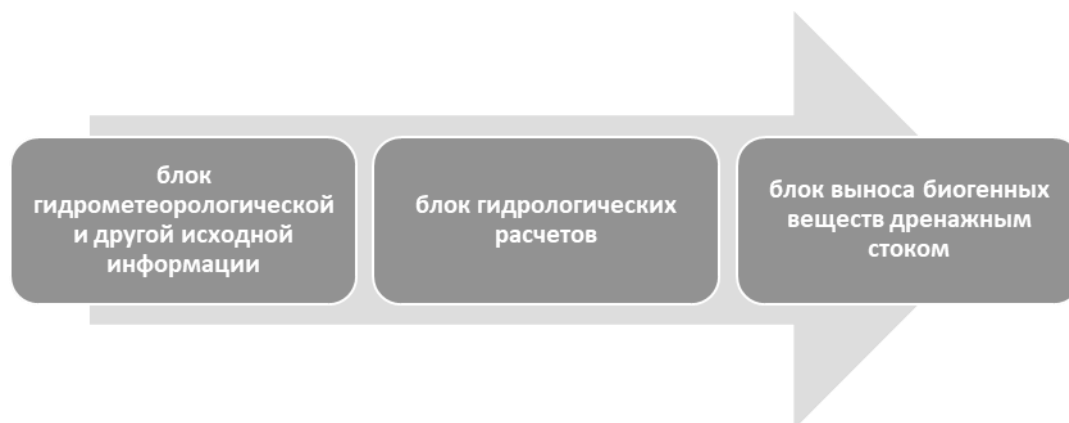
Рисунок 1 – Общая структурная схема алгоритма расчета выноса биогенных веществ дренажным стоком
