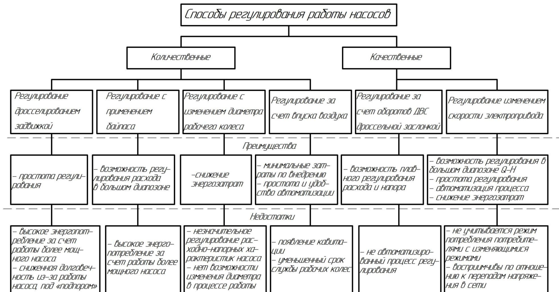
Рисунок 7 – Способы регулирования работы насосов насосных станций
