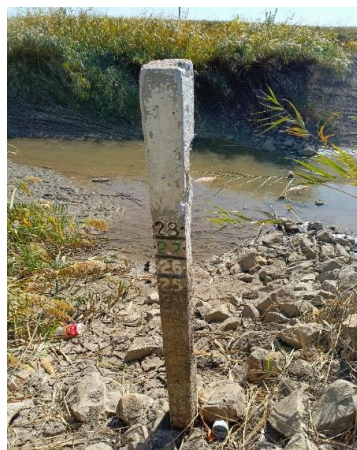
Тарированный столб на промежуточном пикете Calibrated post on the intermediate station
