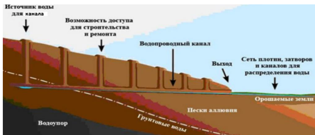
Рисунок 5 – Схема устройства подземного канала в Персидской империи
