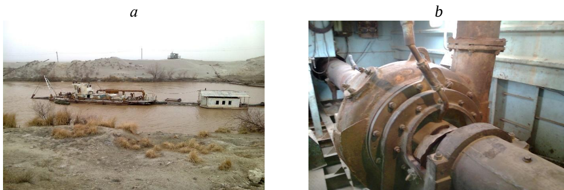
a – работа земснаряда марки ЗРСГ-2Г с габаритами 22,5 \times 6,15 \times 4,9 м; b – агрегат земснаряда
