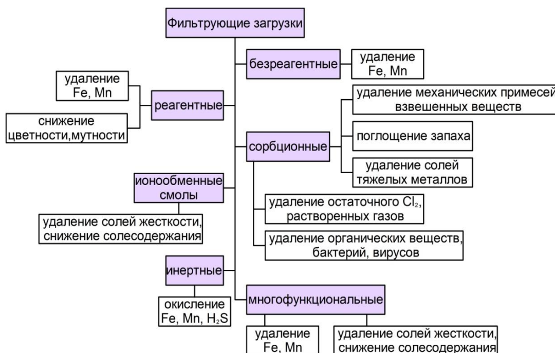
Рисунок 3 – Систематизация фильтрующих загрузок в зависимости от удаляемых загрязнителей
