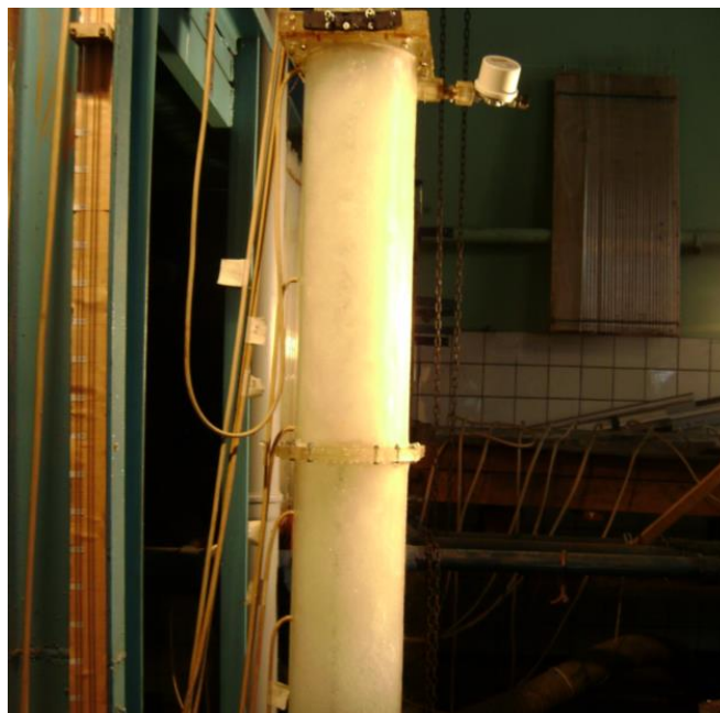
Рисунок 4 – Пьезометры, установленные на шахте (автор фото Н. В. Ханов)
