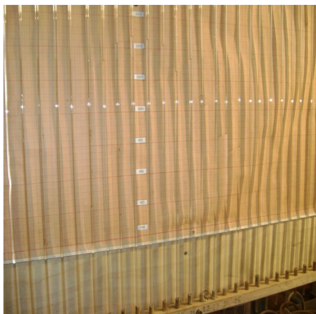
Рисунок 5 – Фото пьезометрического щита с показаниями пьезометров (автор фото Н. В. Ханов)
