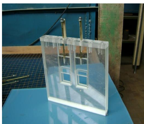
Рисунок 9 – Фото конструкции затворной камеры с двумя затворами с острой кромкой (автор фото Н. В. Ханов)
