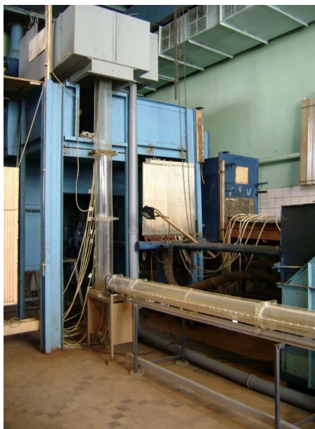
Рисунок 6 – Головной участок и отводящий туннель модели водосброса Рогунской ГЭС (автор фото Н. В. Ханов)
